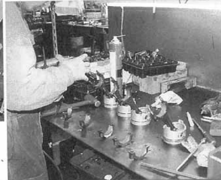
ピストンをシリンダーブロックに組み付ける前の工程で、コンロッドの大端部にメタルを組み込んでいるところ。
