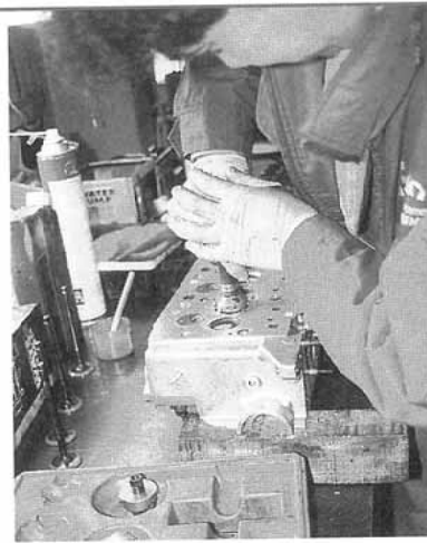
ディーゼルエンジンを生産することが少なくない。これも4気筒のディーゼルエンジンのシリンダーヘッドで、バルブのあたりを調整しているところ。
